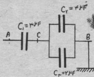
هر گاه نقطه B به زمین وصل باشد و نقطه A را به پتانسیل ۲۰۰۰ ولت وصل کنیم، مطلوب است محاسبه میزان بار روی هریک از خازنها و پتانسیل نقطه C.
