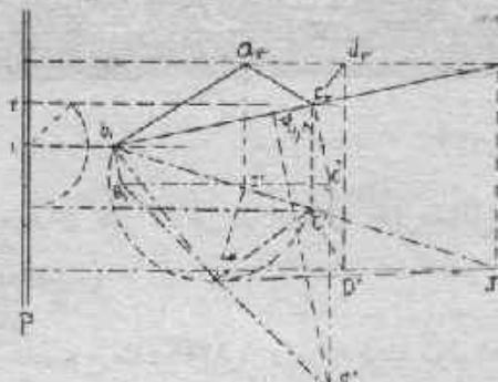
نقاط  $d$  و  $e$  به کمک تسطیح سفحة  $P$  حول یکی از افقیهایش (در شکل بالا افقیه رقم ۱) بر سفحة مقایسه بددست می‌آیند.
